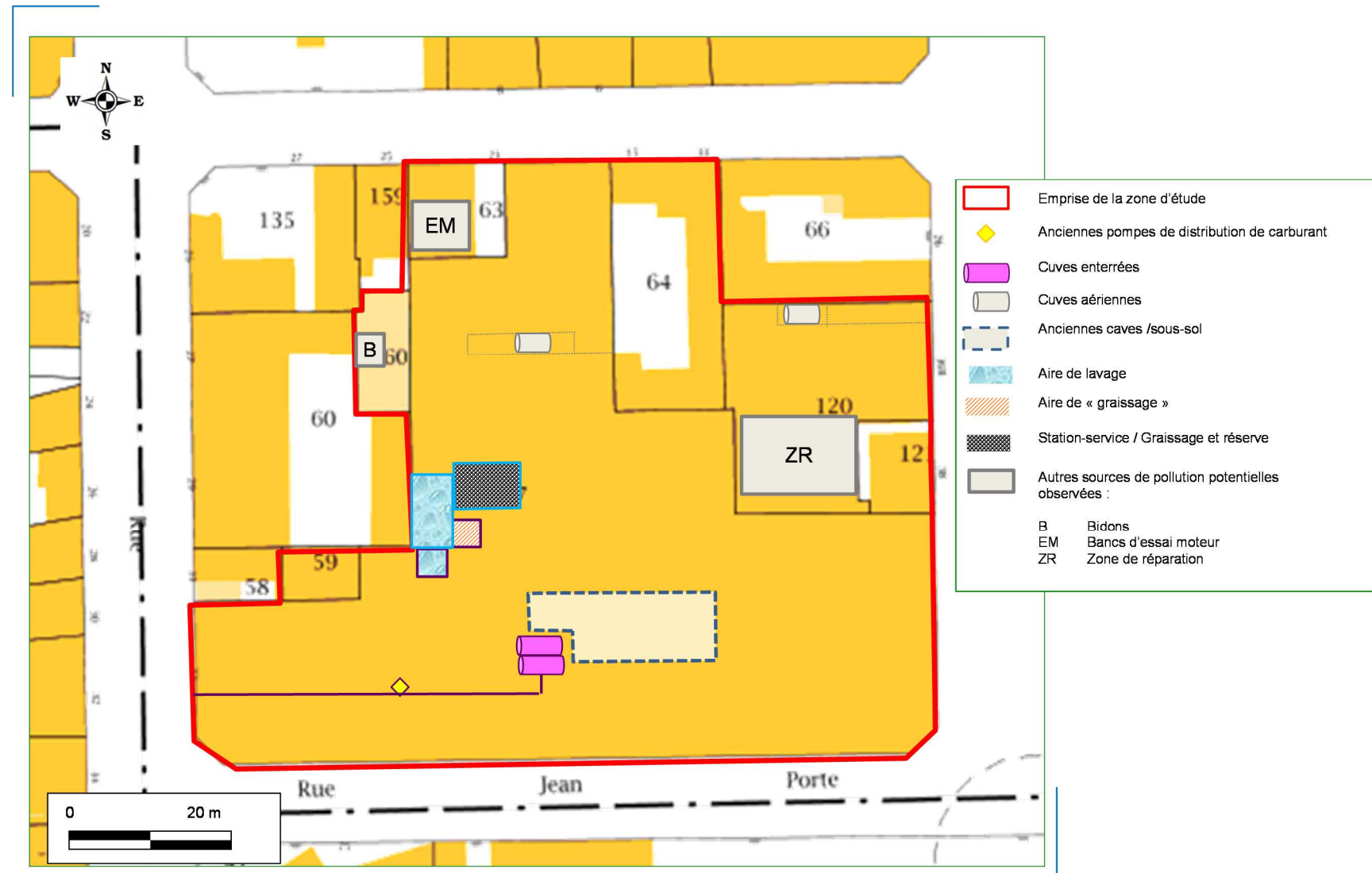
Figure 7 : Sources potentielles de pollution recensées lors de la visite de site effectuée le 21/04/2017 sous fond cadastral (Source : Cadastre.gouv.fr)
